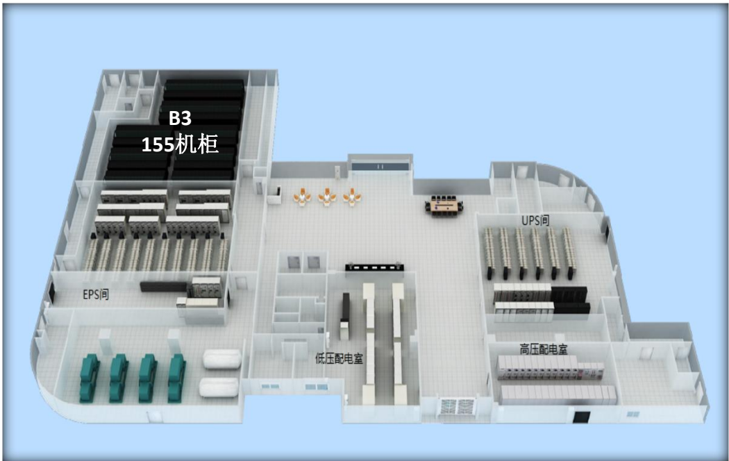
一楼由基础设施机房+B3机房组成
